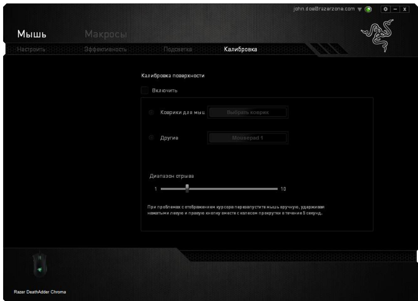
Параметр ДИАПАЗОН ОТРЫВА позволяет задать значение расстояния, при котором датчик перестает функционировать при отрыве мыши от рабочей поверхности. Чтобы использовать данную возможность, сначала необходимо активировать параметр КАЛИБРОВКА ПОВЕРХНОСТИ, а затем выбрать соответствующую рабочую поверхность. При активации параметра КАЛИБРОВКА ПОВЕРХНОСТИ необходимо выбрать тип рабочей поверхности, соответствующий используемому в данный момент типу поверхности.
